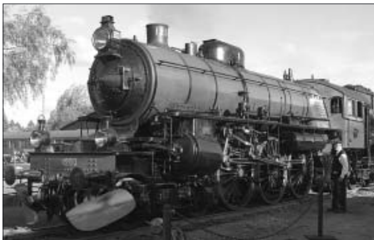
Snälltågsloket F1200, SJs största väger 143 ton med största hastighet 90 km/tim. Byggt 1914. Kvaddat vid Getå-raset 1918 men bärgat och reparerat. Sålt till Danmark 1937, men återköpt efter kriget till Järnvägmuseet.
